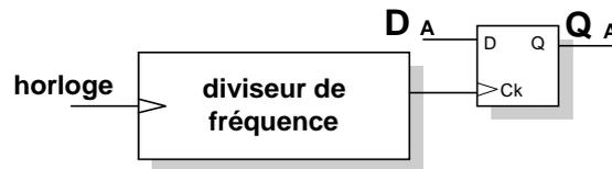
Le montage suivant, où les horloges sont communes, mais où la ou les bascules d'acquisition de  $D_A$  lisent  $D_A$  une fois sur  $K$  coups d'horloges, et leur propre sortie les  $K-1$  coups restants, permet de résoudre le problème.
